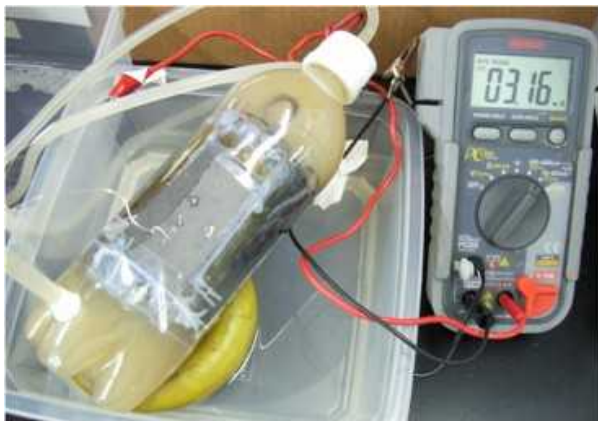
単槽型電池で澱粉液を浄化し高出力発電(3mA, 0.55V)
